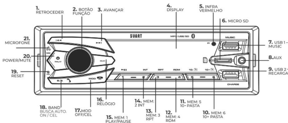
1 - Na função RÁDIO, pressione para sintonizar a estação desejada. Na função MP3, pressione para voltar à faixa anterior.
