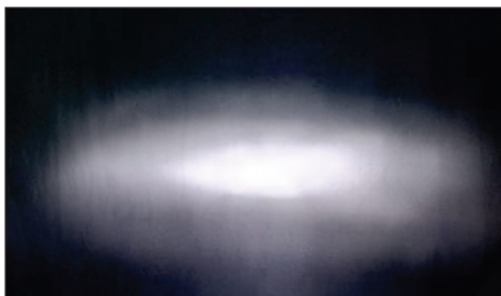
Immagine reale della proiezione di una lampada alogena H4
